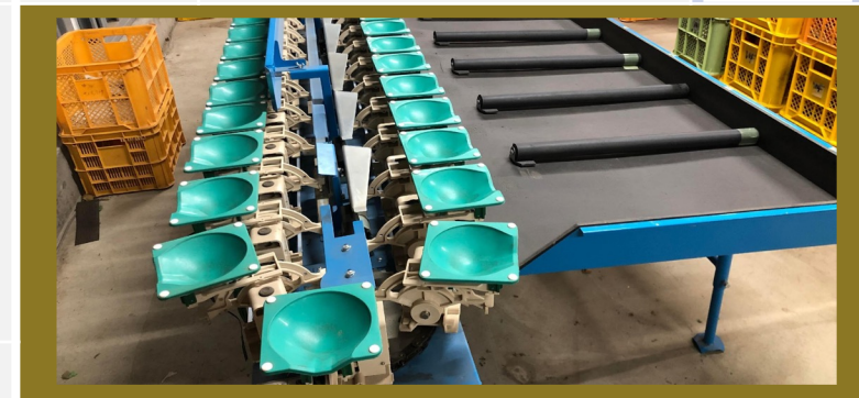
重量別選果機(上) 重量別にコンテナへ移動(下)
