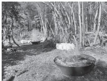
図4 開放型炭化器による竹炭製造
