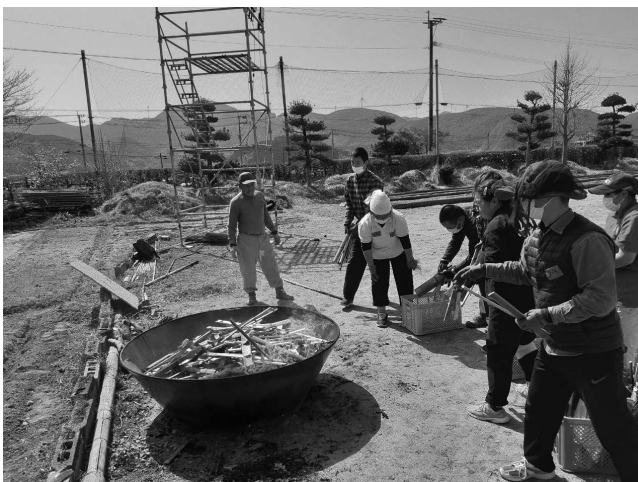
図7 開放型炭化器による竹炭製造（薩摩川内市） 出所：筆者撮影
